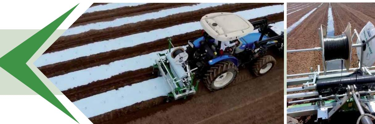
Indiquée pour un parfait déroulage et un ajustement réglable de toiles de paillage en matière plastique, biodegradable ou papier, avec une vaste gamme de modèles **pour toiles de longueur maximale de 300 cm**. Grâce à sa solidité particulière, elle peut être utilisée sur des sols durs, buttés ou en présence de plates-bandes, ainsi que sur des sols plans.
