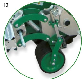
Parallelogramma con ruota in gomma flex regolabile
