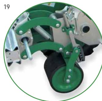
Parallelogramma con ruota in gomma flex regolabile
