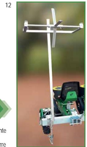
Supporto per la bobina della manichetta per irrigazione con vomere interrante
