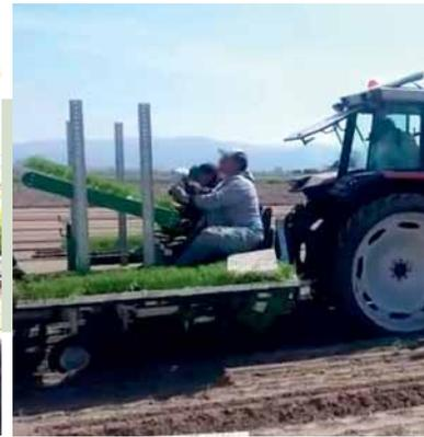
La Trapiantatrice è dotata di bicchieri distributori perforatori rotanti verticali che consentono di trapiantare su films plastici, biodegradabili, cartacei, su terreno nudo, in serra ed in campo aperto piantine di ortaggi in genere con zolla di torba conica e cilindrica max cm. 7 di diametro e cubica max cm. 6x6 e si adatta anche ad aglio, patate e semi vari. **Distanze inter-fila regolabile min.cm.27 max a richiesta. Distanze inter-piante regolabile min. cm. 15 max cm. 162.**
