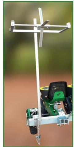
Supporto per la bobina della manichetta per irrigazione con vomere interrante
