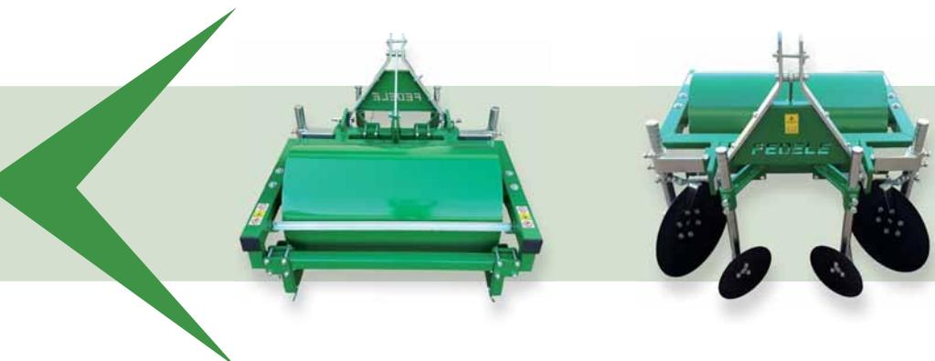
La robusta struttura in acciaio le permette di realizzare aiuole senza problemi su qualsiasi tipologia di terreno lavorato. È dotata di 2 dischi concavi rotanti esterni e di 2 dischi concavi rotanti interni (regolabili in larghezza e in profondità). I dischi rimuovendo la terra la convogliano dentro le pareti formatrici e sotto il rullo che compatta e livella la superficie dell'aiuola. Disponibile anche in versione combinata aiuolatrice + pacciamatrice Eco+Thomas.
