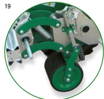
Parallelogramma con ruota in gomma flex regolabile
