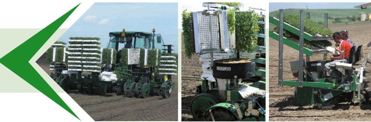
Полуавтоматическая рассадопосадочная машина с **одним операторским местом на каждые 2 ряда**. Оснащена горизонтальным поворотным механизмом подачи с 24 стаканами. Отличается высокой производительностью и позволяет вдвое сократить затраты на персонал.
