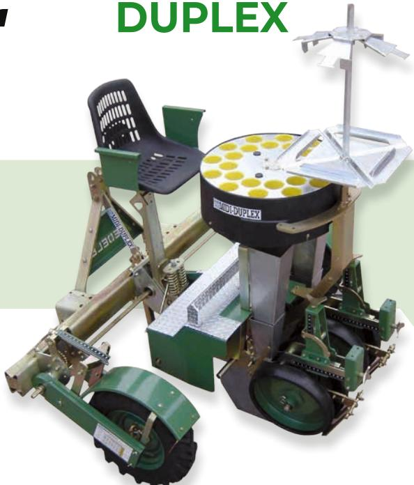
Trapiantatrice semiautomatica con postazione **mono operatore ogni 2 file**, provvista di alimentatore rotante orizzontale a 24 bicchieri. Si distingue per l'ottima produttività combinata con il **dimezzamento dei costi del personale addetto**.
