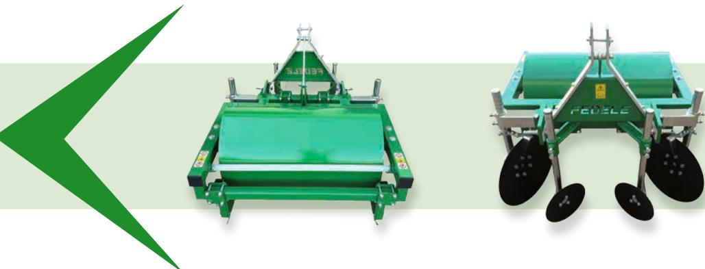
La robusta struttura in acciaio le permette di realizzare aiuole senza problemi su qualsiasi tipologia di terreno lavorato. È dotata di **2 dischi concavi rotanti esterni e di 2 dischi concavi rotanti interni** (regolabili in larghezza e in profondità). I dischi rimuovendo la terra la convogliano dentro le pareti formatrici e sotto il rullo che compatta e livella la superficie dell'aiuola. Disponibile anche in versione combinata aiulatrice + pacciamatrice **Eco+Thomas**.
